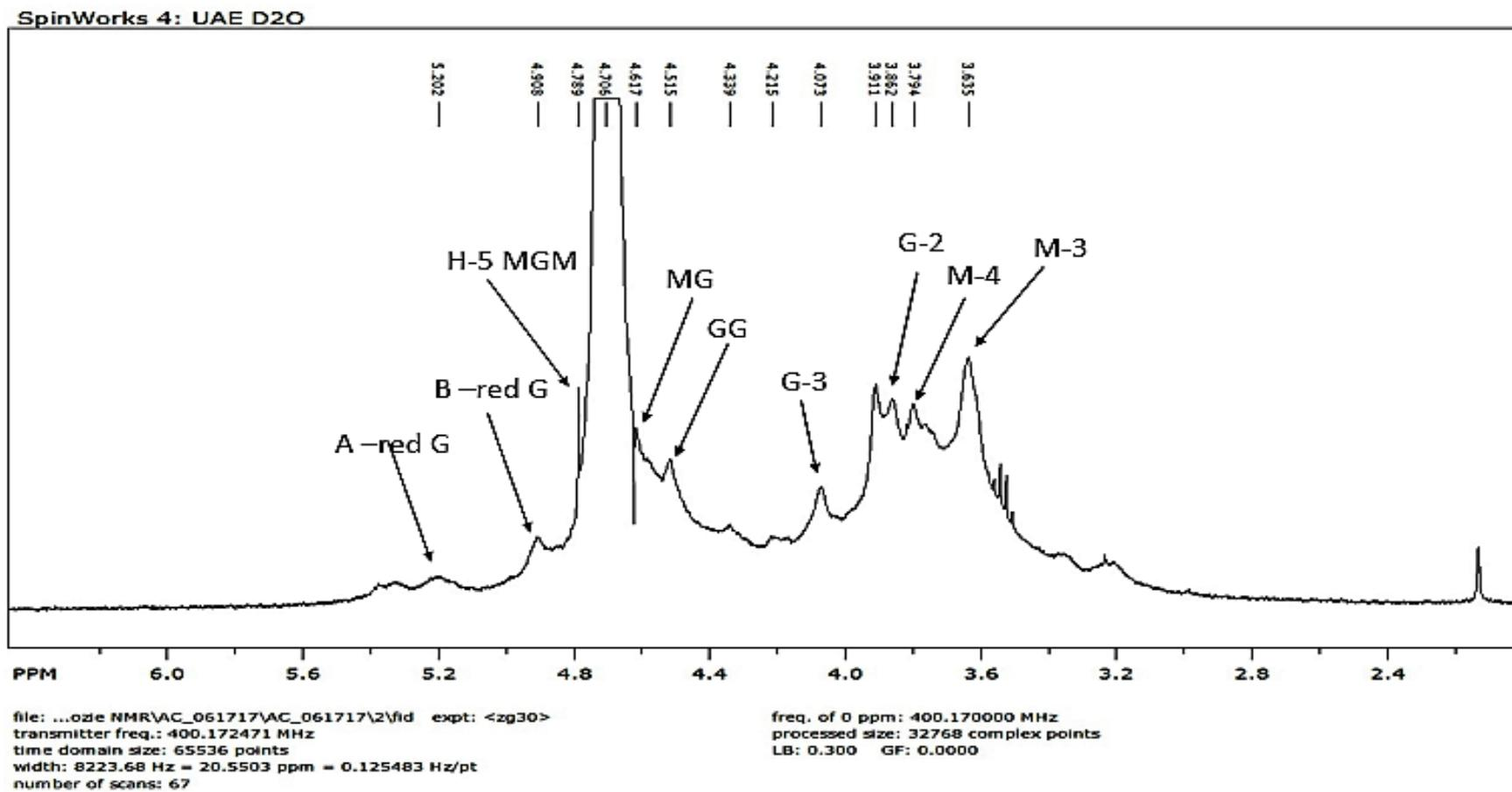
FIG 4.4. THE  $^1\text{H}$  NMR SPECTRUM OF SODIUM ALGINATE FROM ULTRASOUND-ASSISTED EXTRACTION (Alg-UAE)
