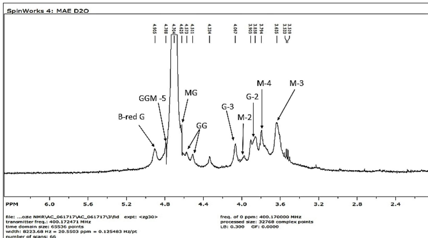
FIG 4.3. THE  $^1\text{H}$  NMR SPECTRUM OF SODIUM ALGINATE FROM MICROWAVE-ASSISTED EXTRACTION (Alg-MAE) (3 $\times$ )
