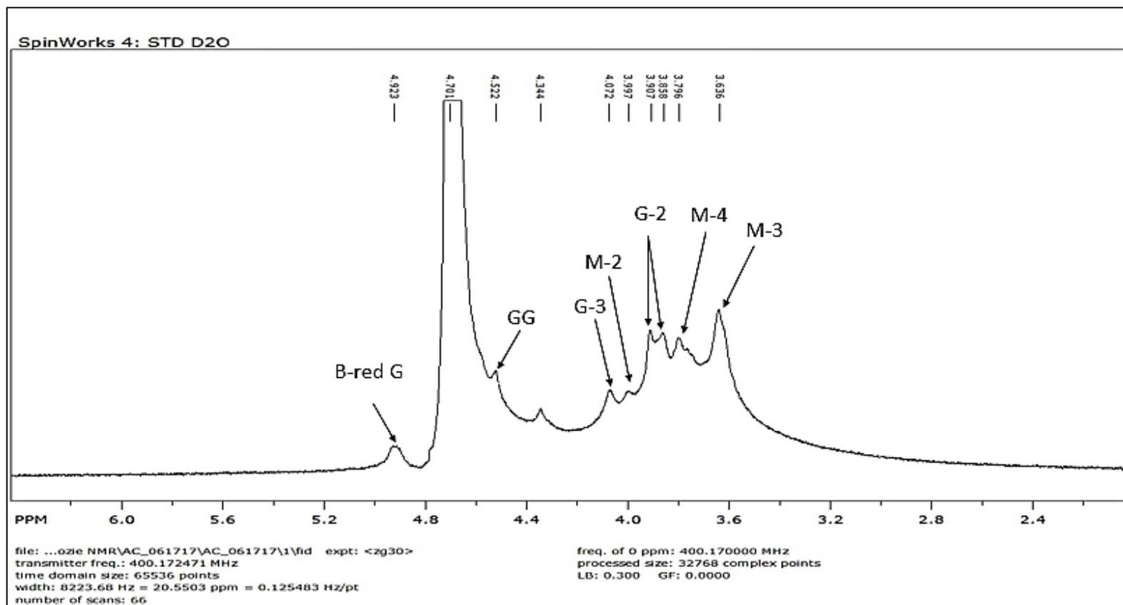
FIG 4.1. THE  $^1\text{H}$  NMR SPECTRUM OF COMMERCIAL SODIUM ALGINATE
